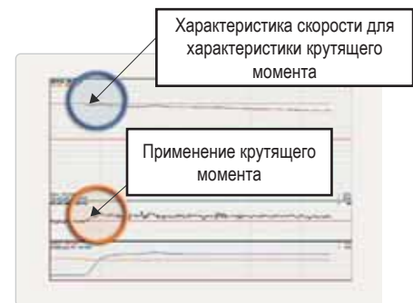
Защита механизма, обеспеченная функцией ограничения крутящего момента
