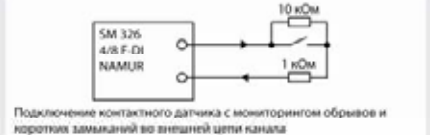
Подключение контактного датчика с мониторингом обрывов и коротких замыканий во внешней цепи канала
